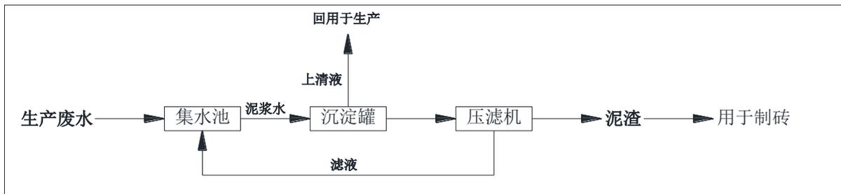
项目生产废水主要来自跳汰机、摇床和打铁机，废水经车间地面汇流至集水池，再通过 PVC 密闭管道进入沉淀罐进行沉淀，上清液回用于生产，沉淀罐池底部含泥水通过泵送入压滤机进行压滤脱水，泥饼主要为砂、土分离的土，可直接送至制砖生产线用于制砖。
