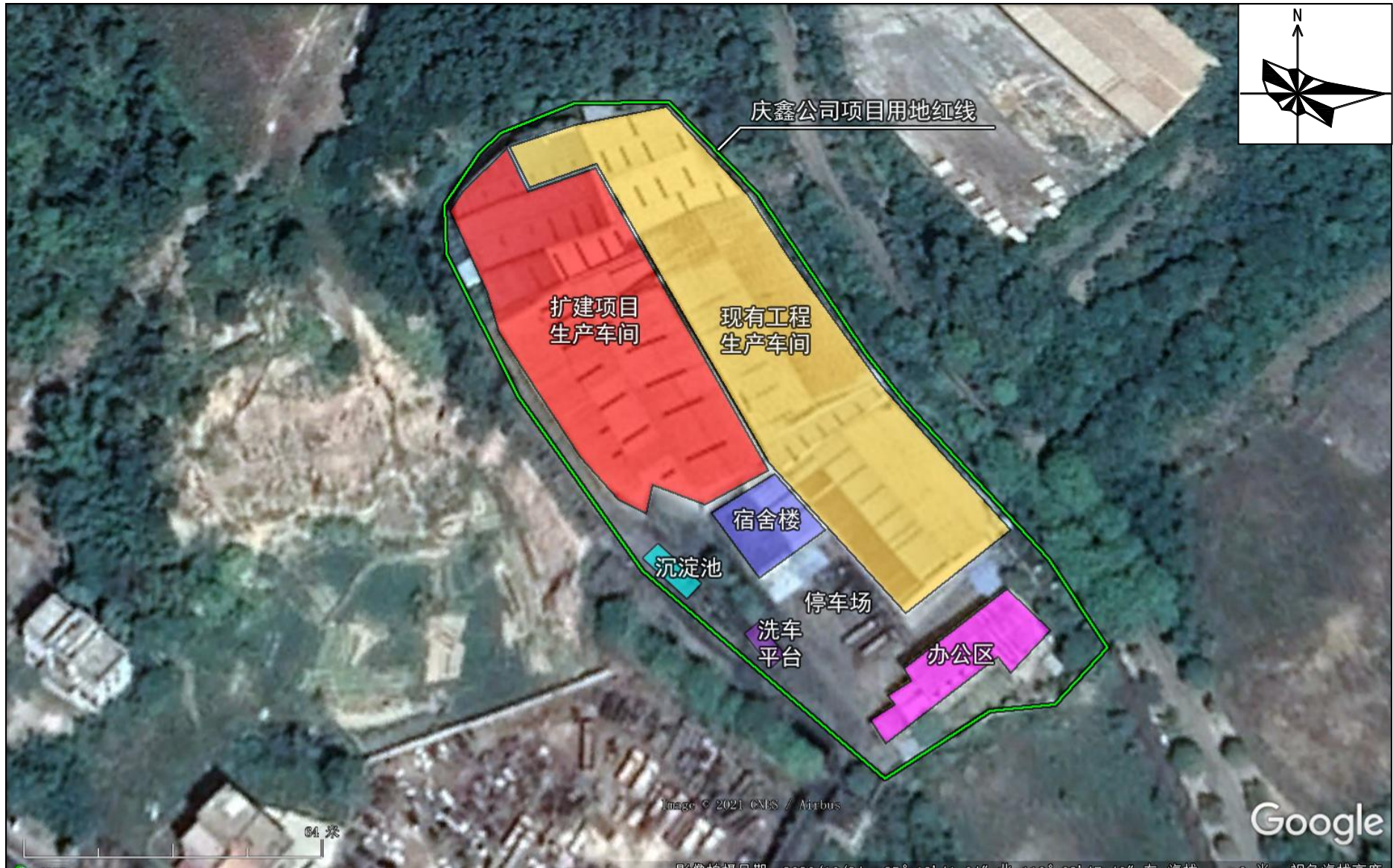
附图 7 扩建后项目全厂总平面布置图
